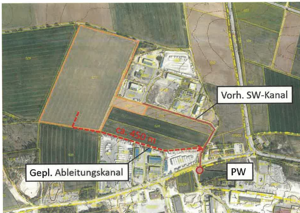
Abbildung 5: Mögliche Trasse für Ableitungskanal Schmutzwasser
